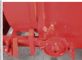
TRANSPORTADOR DE CADENAS MECÁNICO CON 3 VELOCIDADES
