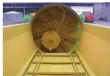
ESPARCIDOR DE TURBINA CON ROTOR DE CORTE Y CUCHILLA RASPADORA
