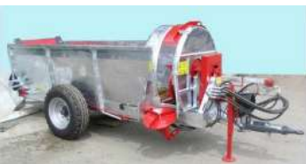
GALVANIZACIÓN EN CALIENTE DE MARCO COMPLETO
