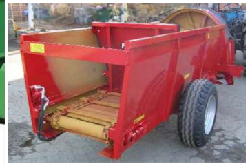
LADO TRASERO MÓVIL CON ALIMENTACIÓN AUTOMÁTICA, ACCIONADO POR CADENAS
