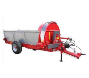
GALVANIZADO EN CALIENTE DE LADOS Y TRASEROS
